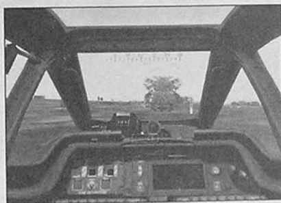
속도 방향선(Velocity Vector)과 미끄러짐 표시기(Skid/Slip Indicator)가 헬기가 좌측으로 이동하고 있음을 표시하고 있다.
